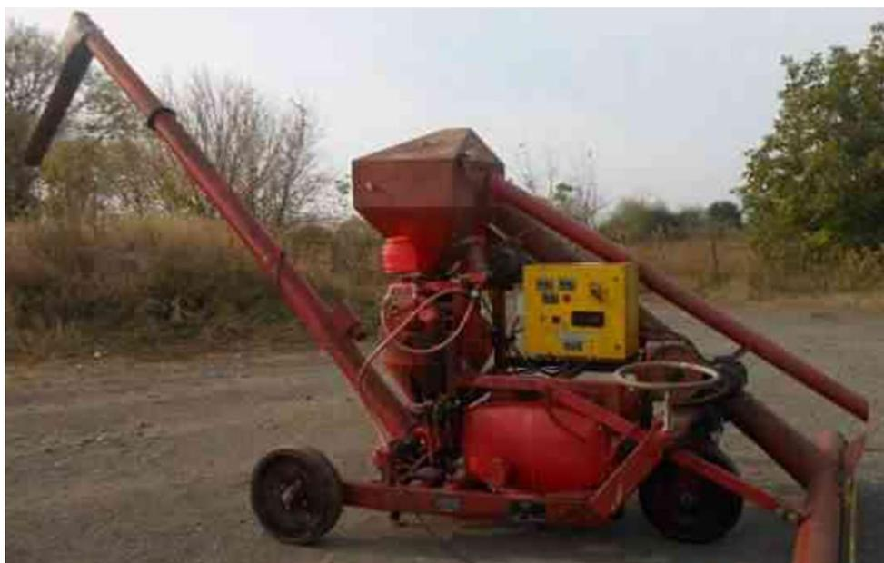
Рисунок 1 – Протравливатель Mobitox Super с двухдисковым распределяющим и двухуровневым отражающим устройствами
