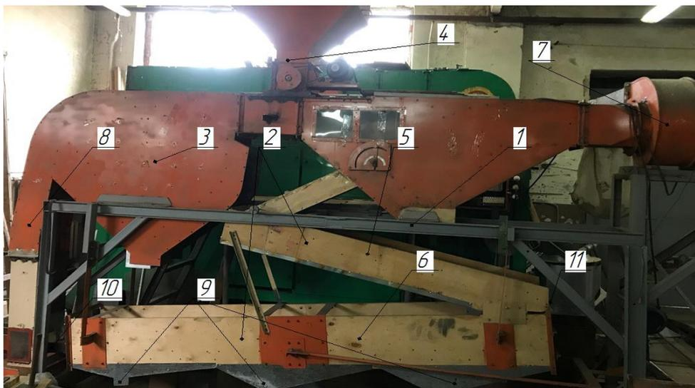
Рисунок 1 – Схема экспериментальной установки: 1 – рама; 2 – решетный стан; 3 – двухаспирационная пневмосистема; 4 – вбрасывающее устройство с загрузочным бункером; 5 – колосовое решето; 6 – сортировальное решето; 7 – центробежный вентилятор; 8 – канал послерешетной аспирации; 9 – лоток для схода фуражной фракции; 10 – лоток для схода очищенного зерна; 11 – лоток для схода крупных примесей.
