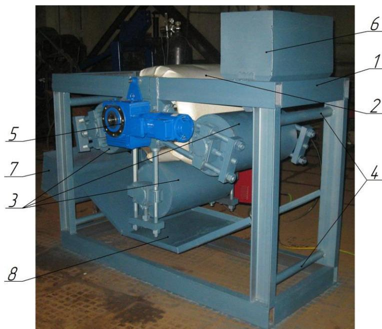
*1 – рама; 2 – пневматический валок; 3 – стальные валки; 4 – поддерживающие ролики; 5 – мотор-редуктор; 6 – загрузочный бункер; 7 – приемный бункер для выжимок; 8 – поддон для сока;*
