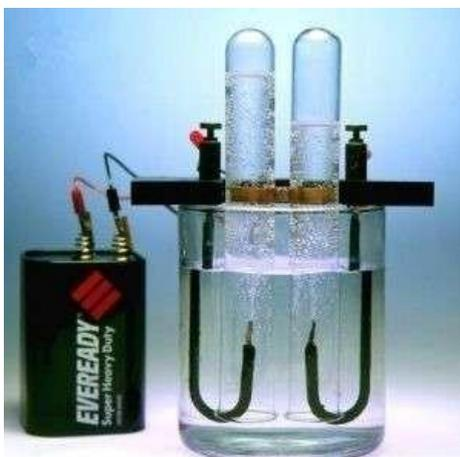
Рисунок 1 Расщепление воды на составные элементы
