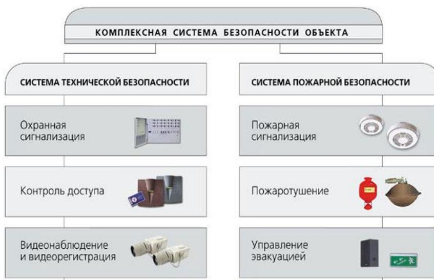
Рисунок 1 - Принципиальная схема системы обеспечения безопасности
