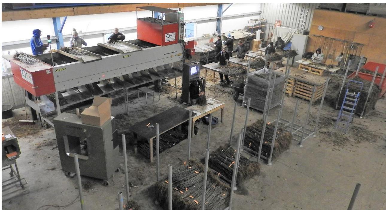
Рисунок 1 – Сортировка клоновых подвоев яблони с помощью автоматизированной линии компаний Tecto Ltd. и GeJo Grading Services (источник изображения: <https://gejogradng.nl/wp-content/uploads/2017/01/GeJo-8-lindeweg-2016.jpg>)
