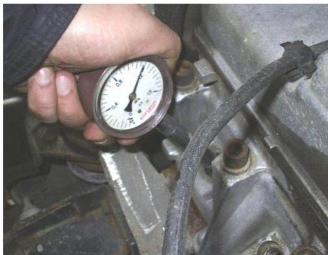
Рисунок 2 - Замер компрессии в цилиндре двигателя: (показание компрессии  $K = 1,2$  МПа)
