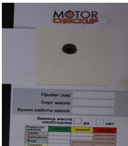
Рисунок 6 - Отпечаток капли моторного масла на тестовой бумаге с колонками для внесения контрольных записей
