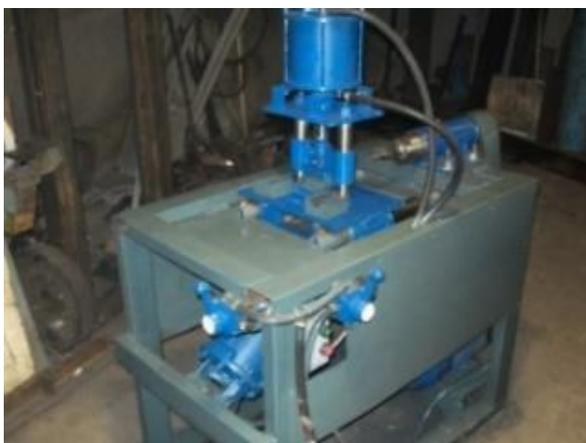
Рисунок 5 – Развальцовщик с электроприводом
