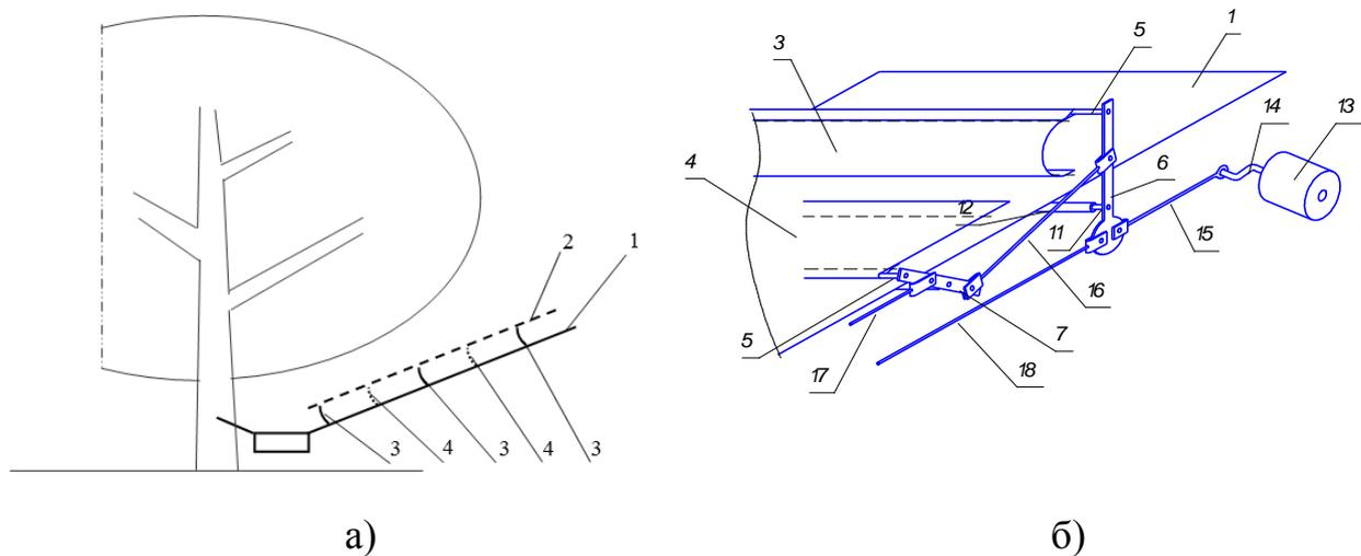
1 – тент; 2 - приемное полотно; 3, 4 - гибкие экраны; 5 – шнур; 6, 7, 8, 9, 10 – коромысла; 11 вал; 12 – втулка; 13 - гидромотор с регулируемой частотой вращения; 14 – кривошипом; 15 – шатун; 16, 17, 18, 19 - систему тяг.
