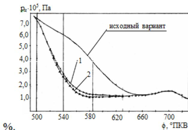
Рисунок 4 - Изменение давления рабочего тела в цилиндре двигателя на участке процесса выпуска
