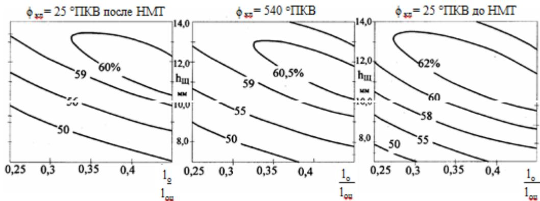
Рисунок 3 - Температура рабочего тела в цилиндре двигателя в конце периода предварительного выпуска
