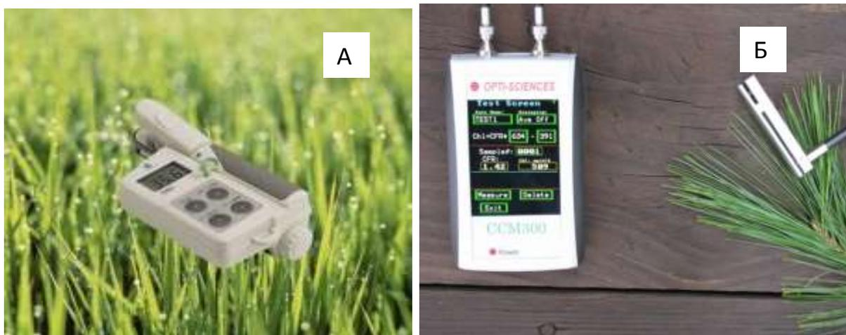
Рисунок 1 - Общий вид хлорофиллометров: А) SPAD-502; Б) CCM-300
