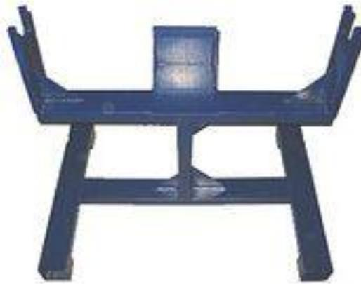
*Рисунок 1* - Стенд для сборки и разборки задних мостов автотранспорта марки М-4111
