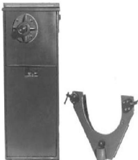
*Рисунок 2* — Стенд для ускоренного ремонта редукторов типа Р-260
