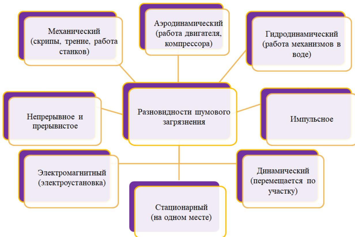
Рисунок 1 – Разновидности шумового воздействия.
