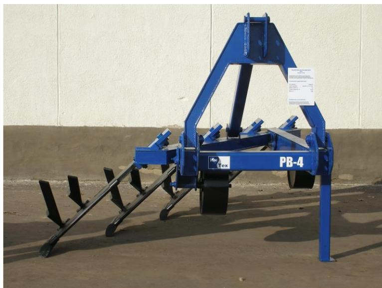
Рис. 3. – Общий вид рыхлителя-вычесывателя РВ
