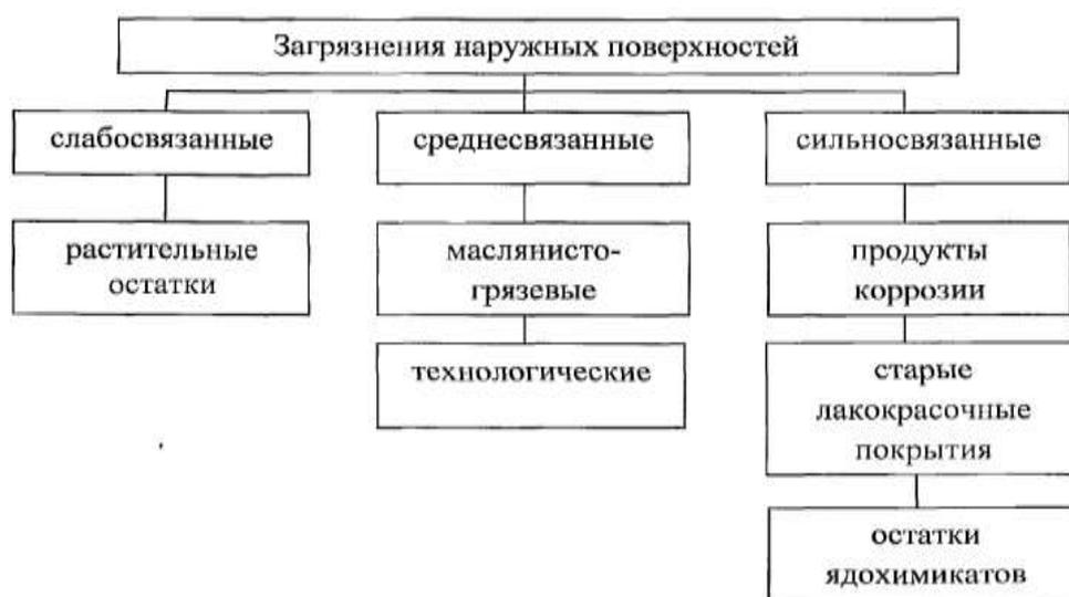
Рисунок 1 - Классификация загрязнений в зависимости от их плотности и трудности удаления
