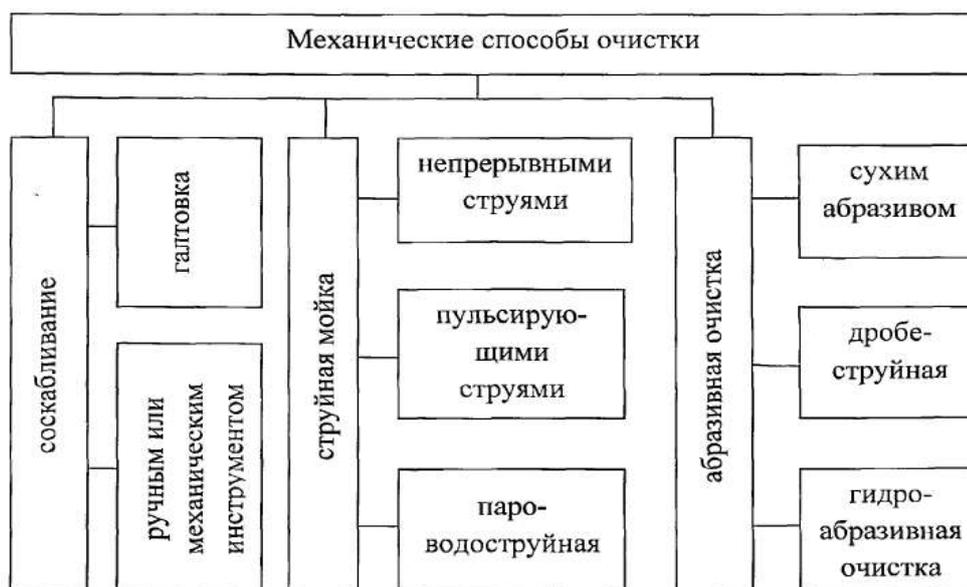
Рисунок 4 - Способы механической наружной очистки машин
