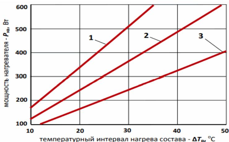
Рисунок 6 - Зависимость мощности нагревателя для напорного резервуара от температурного интервала нагрева мазутного состава и расхода
