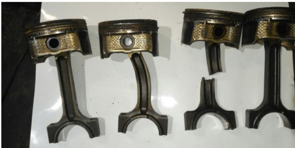
Рисунок 2 – Разрушенные и погнутые шатуны от гидравлического удара
