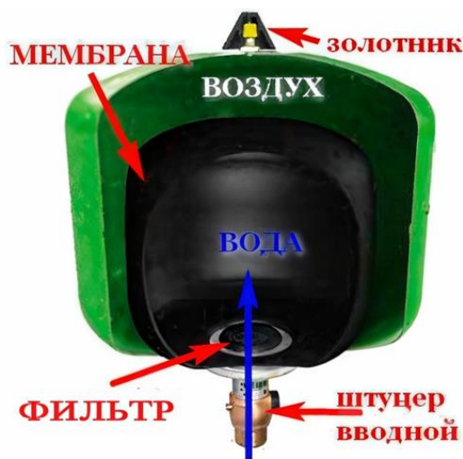
Рисунок 3 – Устройство гидравлического бака
