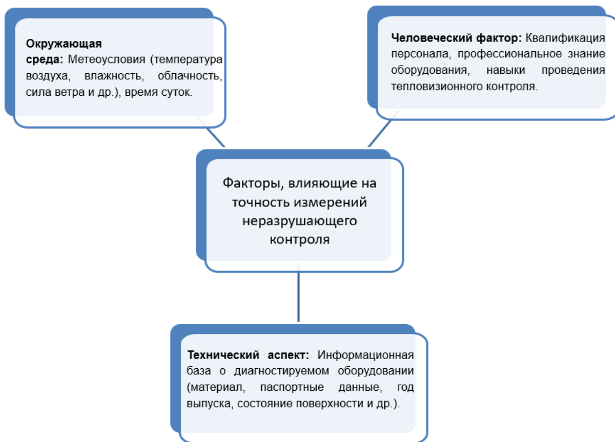
Рисунок 2 - Факторы, влияющие на точность измерений неразрушающего контроля.
