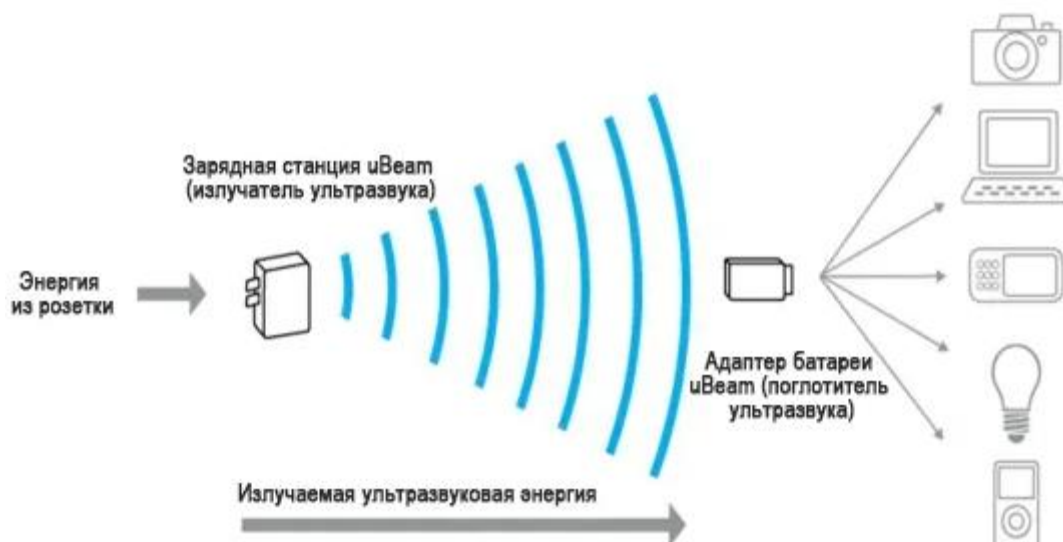
Рисунок 3 – Схема передачи энергии с помощью ультразвуковых волн.
