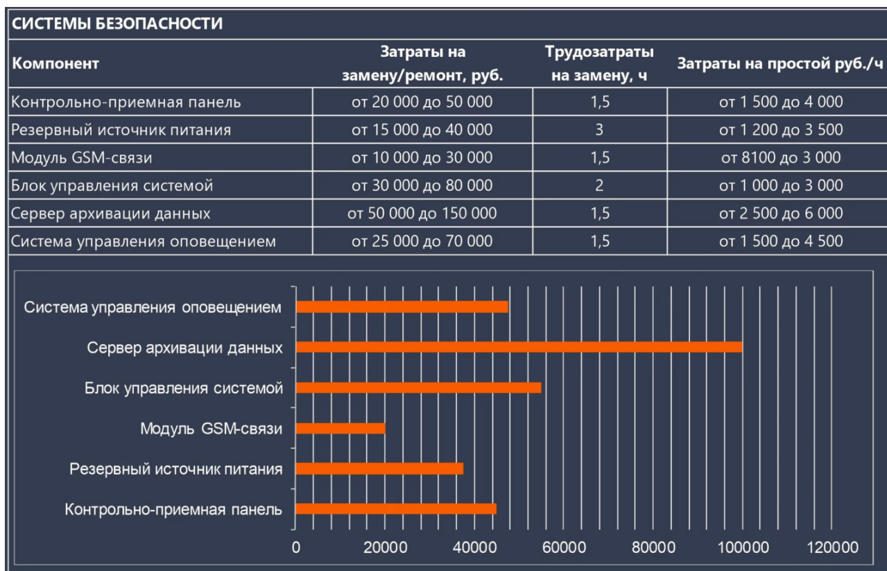
Рисунок 1 - Затраты на замену/ремонт электрического оборудования в системе безопасности.
