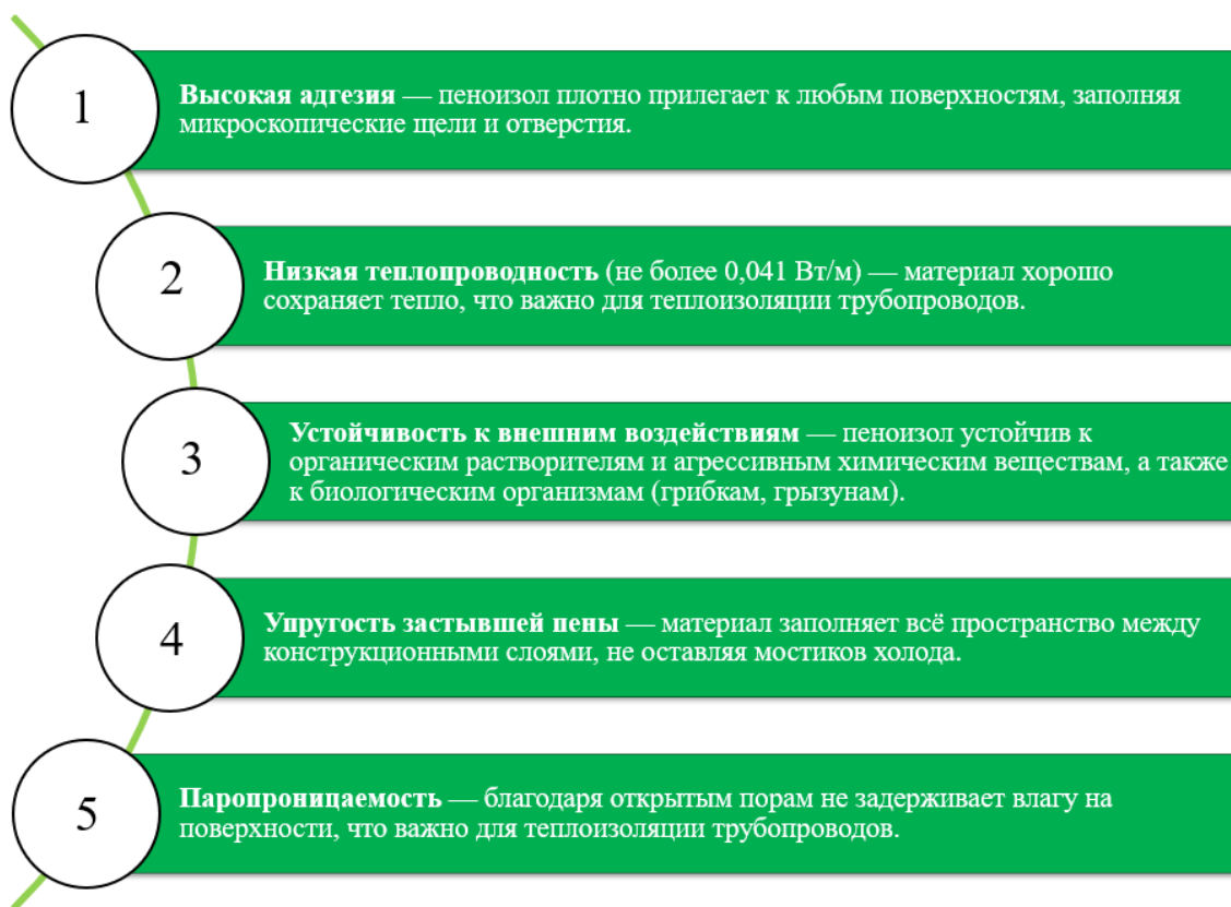
Рисунок 2 – Преимущества пеноизола при использовании в гидравлических системах.
