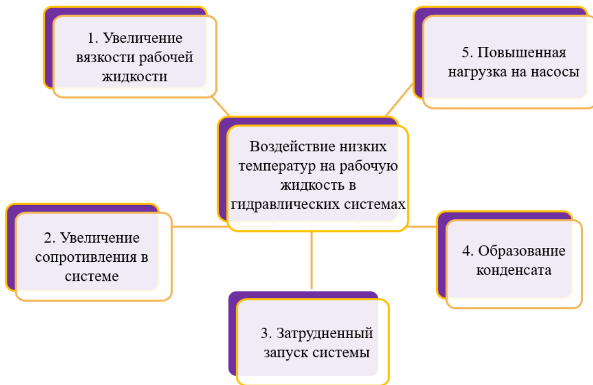
Рисунок 1 - Воздействие низких температур на рабочую жидкость в гидравлических системах.
