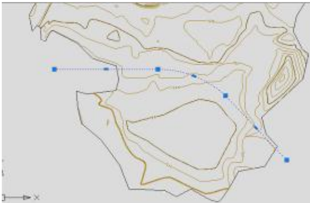
Рисунок 1 - Обработка результатов топографической съемки в комплексе AutoCAD.
